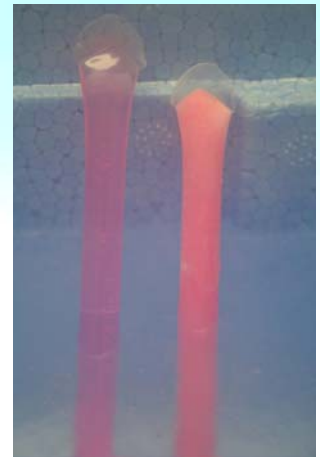
↑液体窒素によりガラス化したサンプル(左)と氷の結晶ができる不透明になったサンプル(右)。
